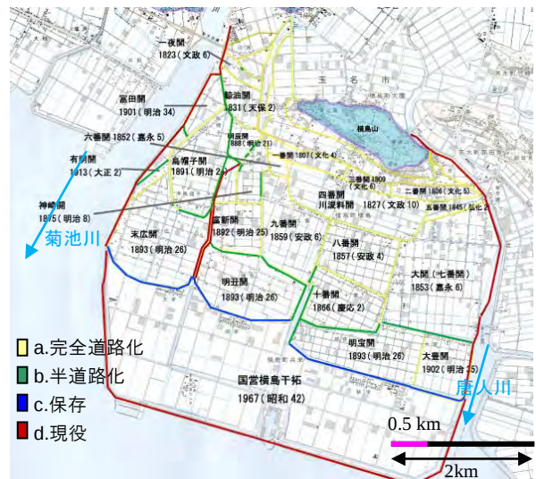
図1 横島干拓地上の旧堤防の現存状態
