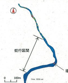
図-1 現況の流速分布 ( Q=0.35\text{m}^3/\text{s} )
